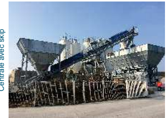
Plant with Skip hoist Centrale avec skip
