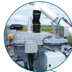
Scales module: cement and water Module des balances à ciment et à eau
